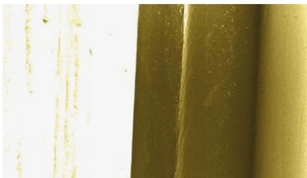
LPKFハイブリッド溶着の溶着線は完璧(150倍)
