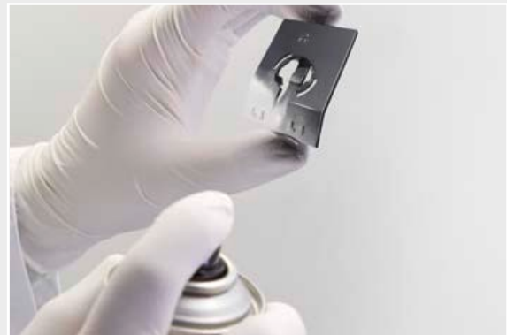
2. Lackieren des Grundkörpers mit LPKF ProtoPaint LDS
