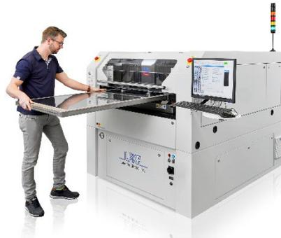
**Der neue LPKF StencilLaser G 60120 erweitert den Arbeitsbereich auf 600 mm x 1200 mm – bei gleichbleibender Präzision und Performance.**
