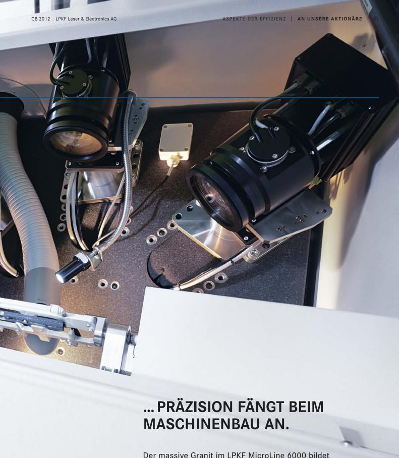
Der massive Granit im LPKF MicroLine 6000 bildet ein sicheres Fundament, um die theoretische Präzision der Laser in ebenso präzise bearbeitete Leiterplatten umzusetzen. Auch bei den LPKF-Fusion-Systemen setzen wir auf diese solide Basis.
