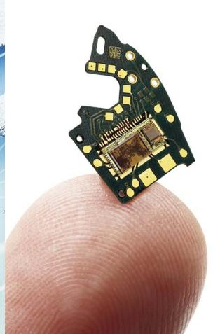
Dort, wo viele elektrische und mechanische Funktionen auf engstem Raum untergebracht werden müssen, kommen Schneid- und Strukturierungslaser von LPKF zum Einsatz. PCB-Laser ermöglichen es, filigrane Schaltungsträger auszuschneiden, ohne empfindliche Bauteile und Leiterbahnen zu beeinträchtigen. Im LDS-Verfahren können spritzgegossene, dreidimensionale Schaltungsträger (MIDs) als Bauteile im Miniaturformat strukturiert werden.
