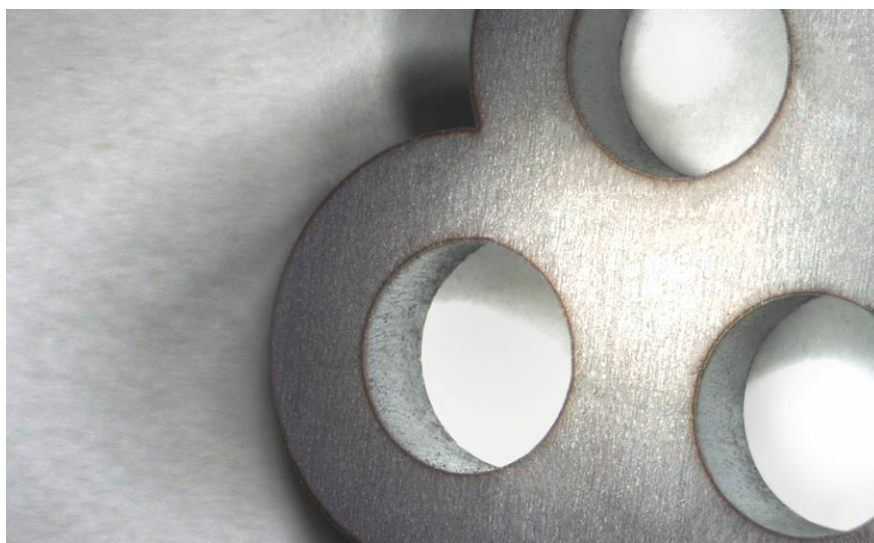
Abb.: Schneidteile aus verschiedenen Metallen und Legierungen mit nahezu beliebigen Konturen lassen sich mit dem Präzision-Lasersystem LPKF PowerCut herstellen.
