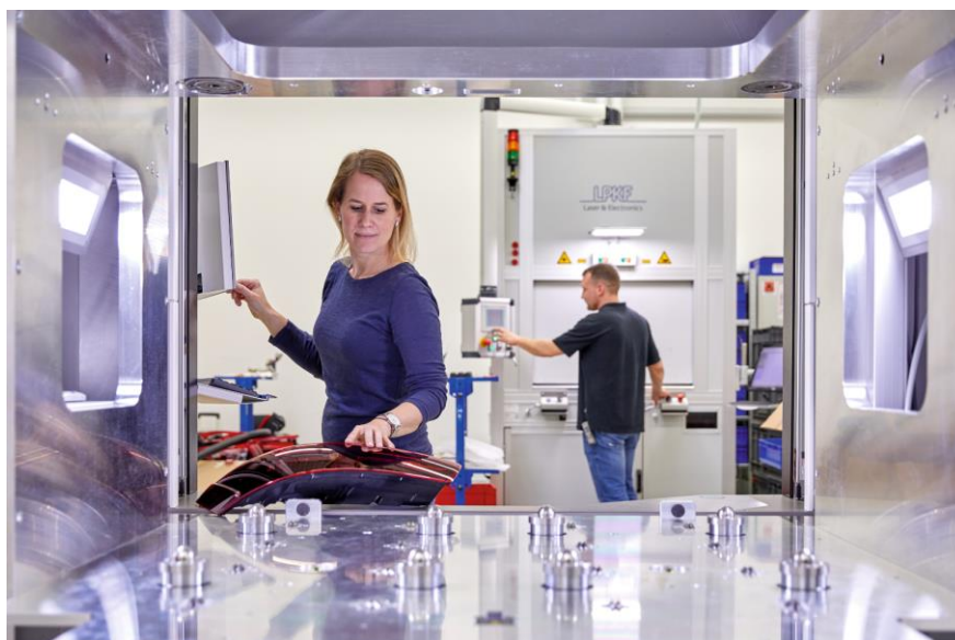
Abb.: Fügen von Automotive-Rückleuchten mit dem Lasersystem LPKF PowerWeld 3D 8000
