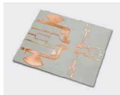
Abb. 4: Gefrästes Filterdesign auf sensiblem Hochfrequenzmaterial
