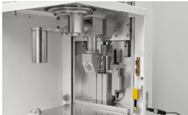
Abb.: Der Rotationsarm in der LPKF InlineWeld 2000 ermöglicht die präzise Strahlführung beim Laserschweißprozess.
