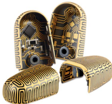
Abb. 2: Künstliche Fingerspitzen: Für die Anwendung in Prothesen- oder Roboterhänden lassen sich mittels LDS-Technologie Leiterbahnen innen und außen präzise aufbringen. Das ermöglicht eine verbesserte Funktionalisierung der Finger.
