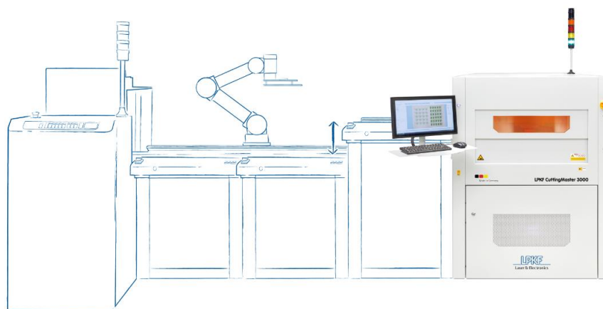
Abb. 2: LPKF CuttingMaster 3000 Ci: Laser-Nutzentrennsystem für die Linie
