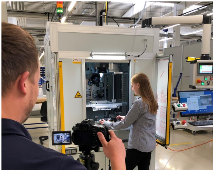
Abb.: Mitarbeiter bei der Abnahme eines Laser-Kunststoffschweißsystems
