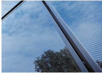
Auf der vorherigen Seite sehen wir einen „Lasergraben“, durch den ein Dünnschichtsolarmodul präzise und materialschonend strukturiert wurde.
