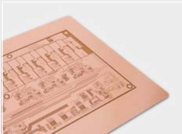
Laserstrukturierte FR4-Boards überzeugen durch eine hohe Übereinstimmung von Layout und realer Geometrie
