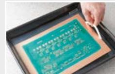
**i** Der Bestückungsdruck mit LPKF ProLegend wird nach dem exakt gleichen Verfahren mit weißem Lack hergestellt. Da gleichfalls die Bereiche belichtet werden müssen, die später farbfrei sein sollen, muss die Filmvorlage negativ bedruckt werden.
