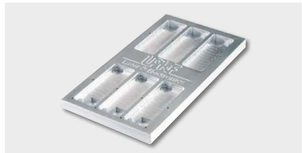
mindestens 60 000 U/min produzieren beim Fräsen bzw. Ausschneiden sehr saubere Oberflächen. Abhängig von der benötigten Frästiefe sind gegebenenfalls mehrere Durchgänge zu fräsen. Als Faustformel gilt, dass die Frästiefe maximal dem halben Werkzeugdurchmesser entsprechen soll.
