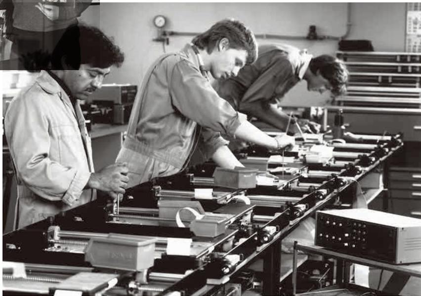
Erste Fräsbohrplotter für kleinere Serienfertigungen
