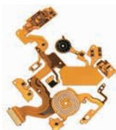
*Volle Flexibilität: präzise, komplexe Schneidkonturen und exakte Bohrungen mit LPKF-Lasertechnologie*
