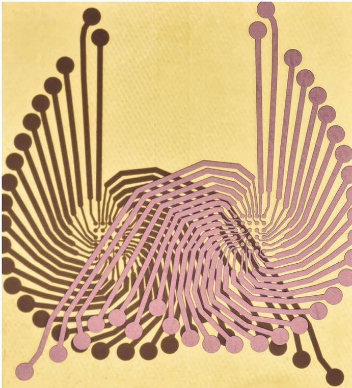
**Bild 4:** Bei dieser doppelseitigen Struktur sind der präzise Abtrag der Kupferschicht sowie die nahezu unbeschädigte dielektrische Schicht deutlich zu erkennen. Die Größe des Musters beträgt 25 x 25 mm<sup>2</sup>.
